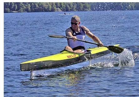
Je ausgefeilter die Tragflügel, desto schneller muss man paddeln, um abheben zu können. Dafür steigt auch die erzielbare Maximalgeschwindigkeit.
