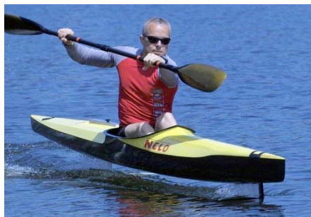
Bald schneller als ein Ruder-Achter? Das Flyak hat Tragflügel unter dem Rumpf, die das Boot aus dem Wasser heben.
